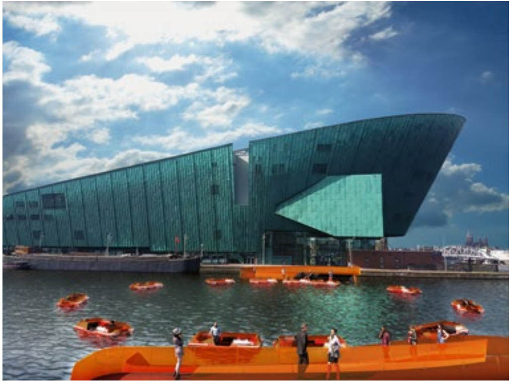
Abb. 4 Darstellung der autonomen »RoundAround«-Brücke mit zwei rampenartigen Anlegestellen und den dazwischen zirkulierenden Roboats (Quelle: Leoni et al. 2019)
